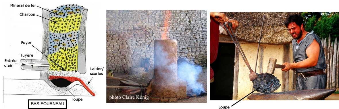
Figure I.6 – Schéma et photos d'un bas fourneau (à gauche et au centre). Photos de l'opération de cinglage (à droite).
