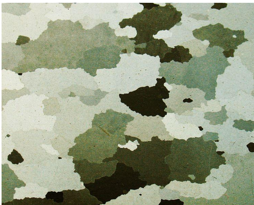
Figure II.13 – Différentes orientations cristallographiques des grains d'un acier électrique.
