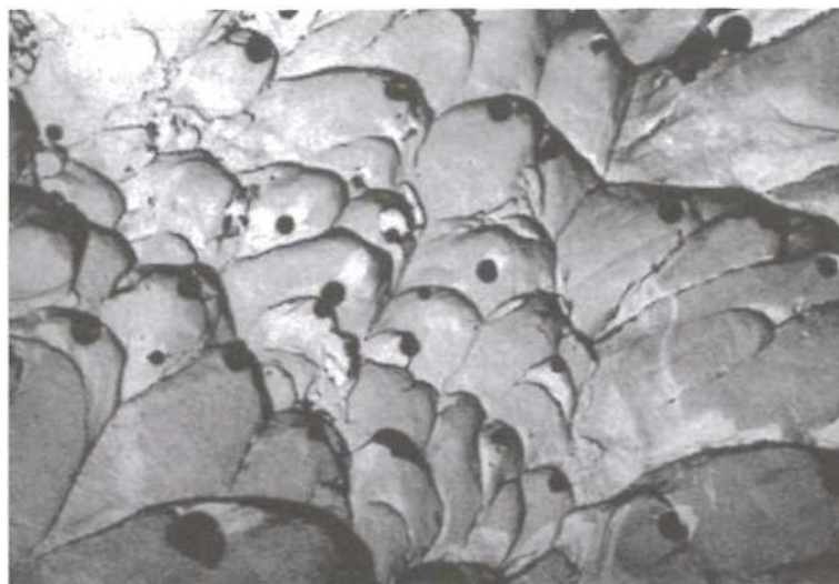
Figure VI.20 – Cupules observées dans un acier doux (réplique MET).
