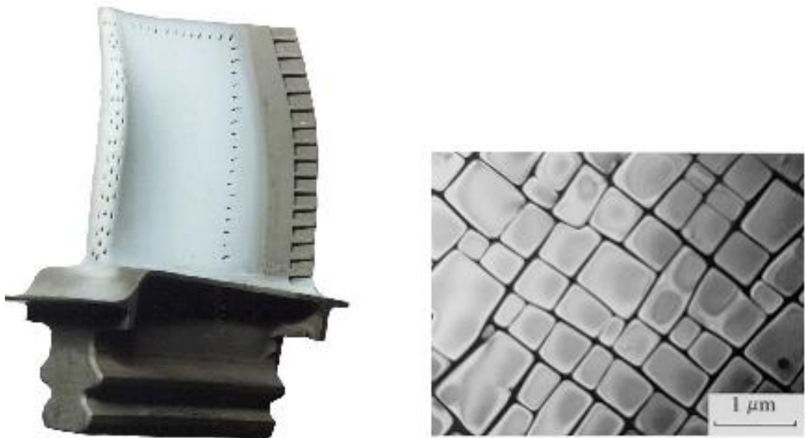
Figure IV.14 – A gauche : aube de turbine ; à droite : image MET de la microstructure d'un superalliage à base nickel MC2.
