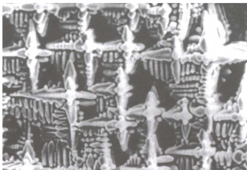
Figure V.2 – Cavité dans une pièce solidifiée tapissée de dendrites.
