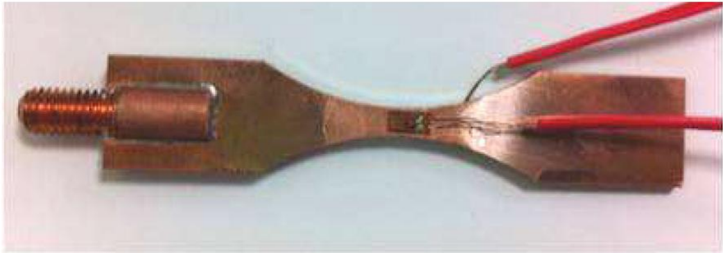
Figure IV.16 – Epreuve de fatigue ultrasonique en cuivre équipée d'une jauge de déformation.
