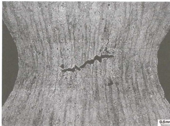
Figure II.24 – Coupe métallographique longitudinale d'une éprouvette de traction dont l'épreuve a été interrompue juste avant la rupture. Mise en évidence d'une fissure en son centre.
