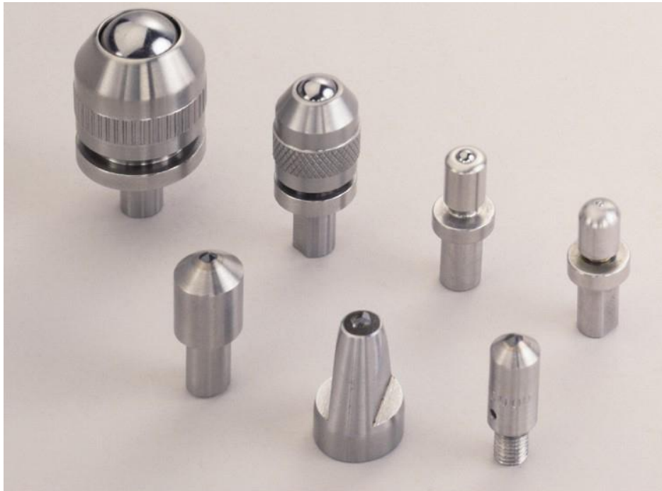
Figure III.6 – Photo des différents types d'indenteurs. En haut les indenteurs Brinell ; à bas de gauche à droite les indenteurs Vickers et Rockell.
